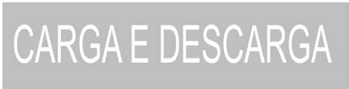
Figura 91 - Sinalização horizontal vaga para carga e descarga
